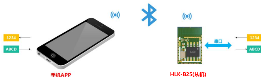
图 1 一对一蓝牙连接透传功能示意图
