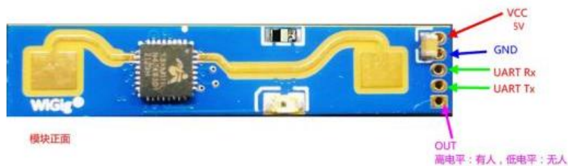
图 6 模块引脚定义图
