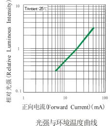
相对光强与正向电流特性 Relative Luminous Intensity VS Forward Current
